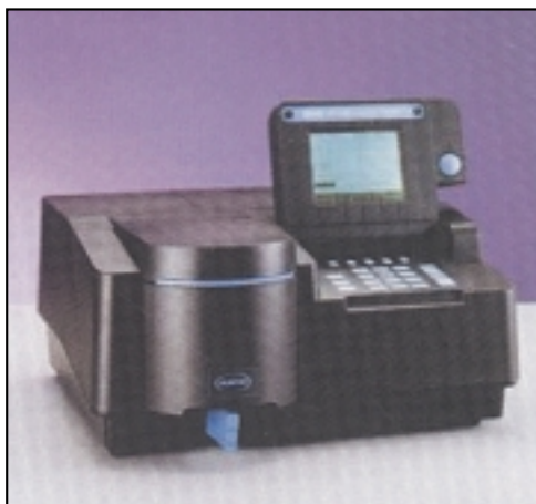
Σχήμα 9.1 Φασματοφωτόμετρο UV-Vis
