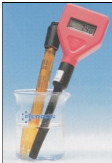
Σχήμα 9.3 Φορητό ψηφιακό πεχάμετρο
